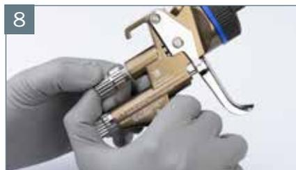
Montar el tornillo de regulación de material
