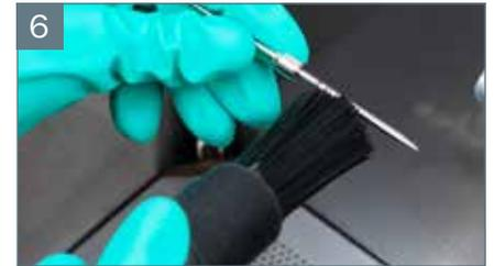
Durante la limpieza de elementos del juego de boquilla se tiene que prestar atención a que la parte de metal de los cepillos no dañe el juego de boquillas. En el caso ideal se utilizan pinceles, cepillos de limpieza SATA y agujas de limpieza de boquilla SATA particularmente fabricados para asegurar un mantenimiento y una limpieza óptimos del juego de boquillas.
