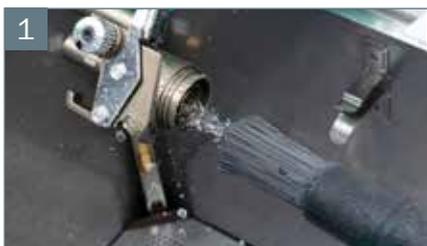
1 Limpeza del conducto de pintura
