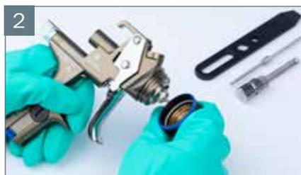
2 A continuación, desmontar la boquilla de aire.
