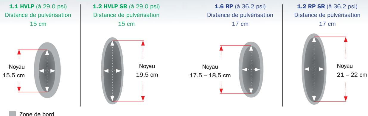
Buses standard avec im noyau mouillé et compact. Buses SR avec noyau élargie.
