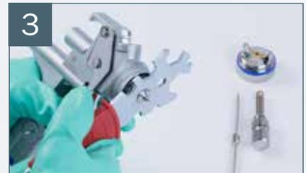
Dévisser la buse de peinture à l'aide de la clé polygonale intégrée dans l'outil universel.
