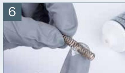
6 Graisser\* et insérer le ressort de l'aiguille de peinture
