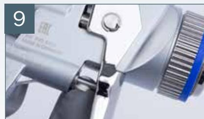
9 Graisser la partie visible de la tige du piston d'air
