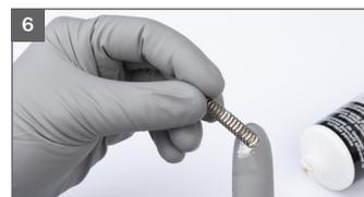
6 Farbnadelfeder einfetten und einsetzen
