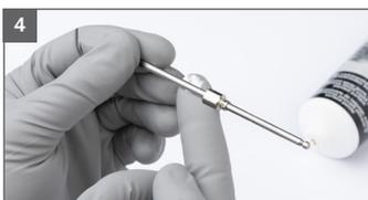
4 Farbnadel im Bereich der Nadeldichtung einfetten
