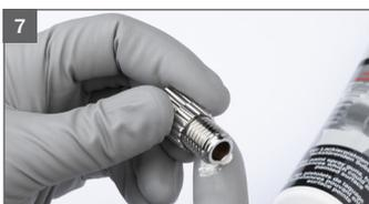
7 Gewinde der Materialmengenregulierschraube einfetten
