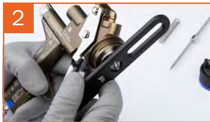
Handfestes Anziehen der Farbdüse mit dem Universalschlüssel
