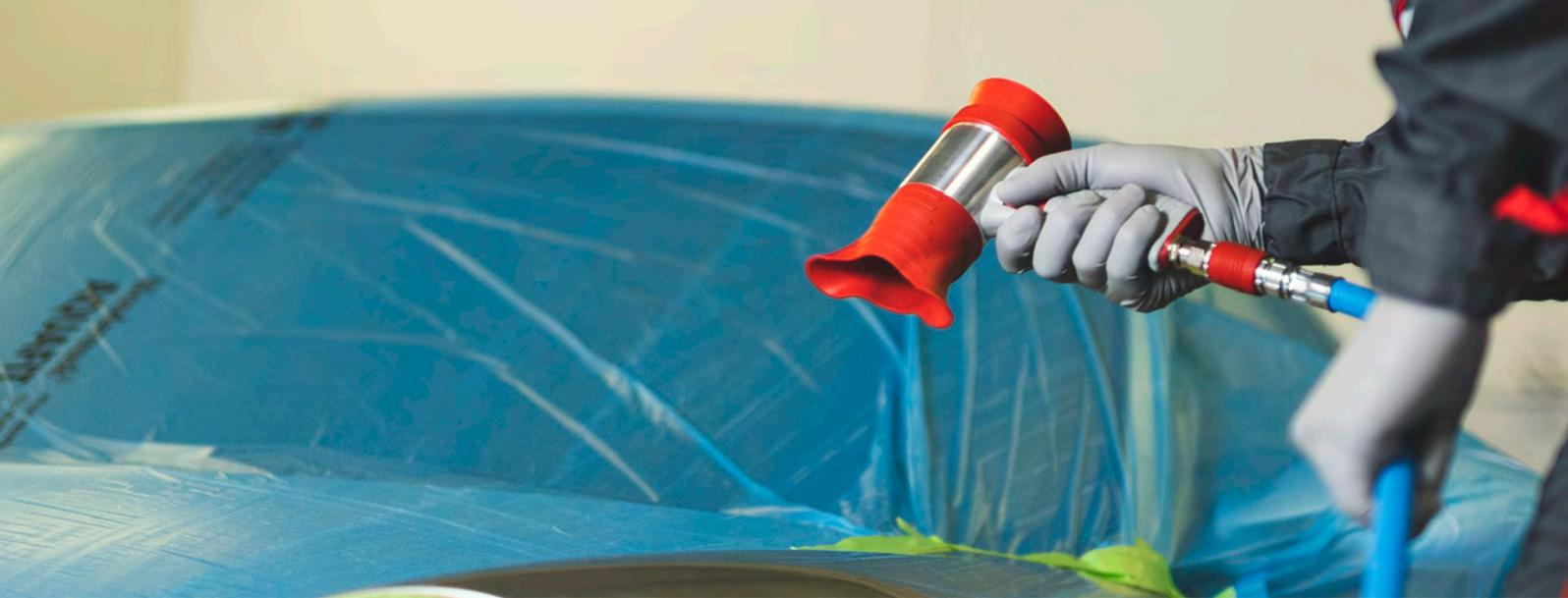
In Lackierbetrieben werden heute in großem Umfang wasserbasierte Lacke verarbeitet. Diese haben längere Ablüftzeiten als lösemittelhaltige Lacksysteme. Die daraus resultierenden längeren Belegungszeiten der Lackierkabinen führen zu einer sinkenden Produktivität des Betriebes. Mit der Trockenblaspistole SATA dry jet 2 können die Ablüftungs- und damit die Kabinenbelegungszeiten erheblich verkürzt werden.
