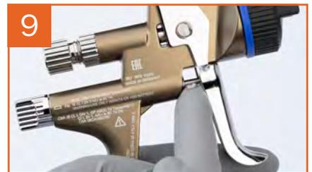
9 Graisser la partie visible de la tige du piston d'air
