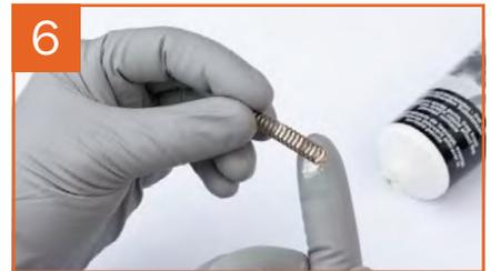
6 Graisser\* et insérer le ressort de l'aiguille de peinture
