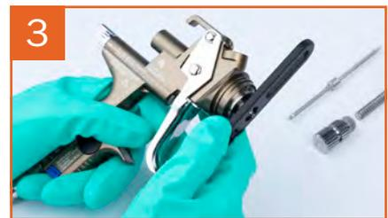
3 Dévisser la buse de peinture à l'aide de la clé polygonale intégrée dans l'outil universel.
