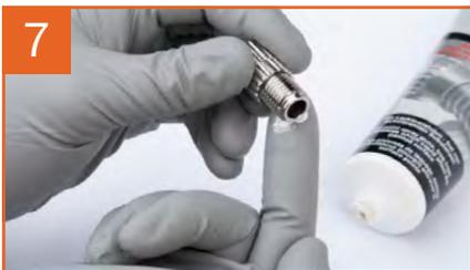
7 Graisser\* le filetage de la vis de réglage de flux produit
