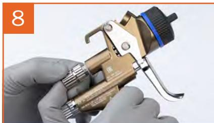
8 Monter la vis de réglage de flux produit
