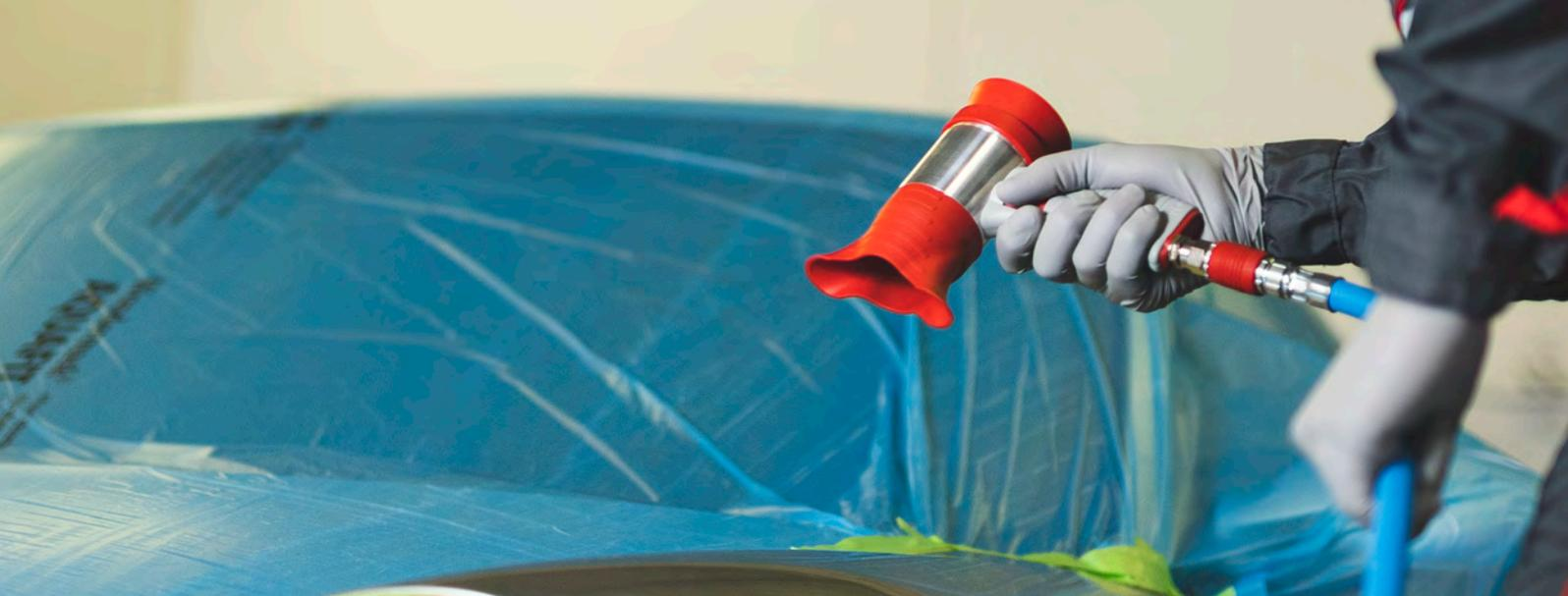
Oggi le vernici a base d'acqua sono ampiamente utilizzate nelle operazioni di verniciatura. Hanno tempi di aerazione più lunghi rispetto ai sistemi di verniciatura a base di solventi. Il conseguente maggiore tempo di occupazione delle cabine di verniciatura porta a una diminuzione della produttività dell'operazione. Con la pistola di soffiaggio a secco SATA dry jet 2 si possono ridurre notevolmente i tempi di aerazione e di occupazione della cabina.
