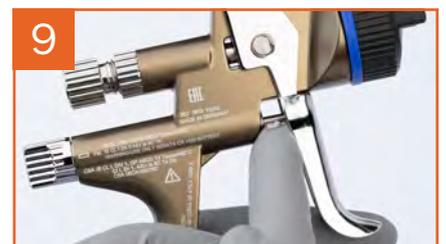
Lubrificare la parte visibile del pistone dell'aria
