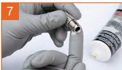
Lubrificare la filettatura della vite di regolazione del materiale \*
