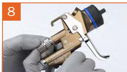
Montare la vite di regolazione del materiale
