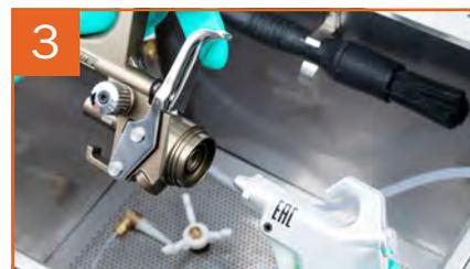
Asciugatura utilizzando la pistola di soffiaggio
