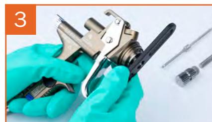
Svitare l'ugello del colore utilizzando la chiave ad anello contenuto nel kit di attrezzi
