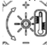
Indicator pentru detectarea mișcării de rotație pentru creșterea sau reducerea puterii încălzitorului.
