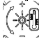
Indikator zur Erkennung der Drehbewegung zur Erhöhung oder Reduzierung der Erwärmerleistung.
