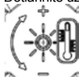
Indikátor na rozpoznanie pohybu otáčania na zvýšenie alebo zníženie výkonu ohrievača.
