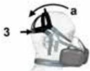
4. 拉动物带 (c) 末端的两侧，直至产品贴合您的面部轮廓。
