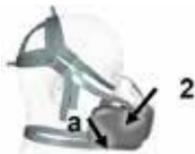
3. С небольшим усилием строньте фильтр A2P3 (2) с посадочного места (a).
