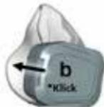
9. Drücken Sie den A2P3 Filter an die Maske (b), bis dieser einrastet und ein deutliches „Klick“ zu hören ist.
