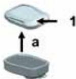
1. Потянув крышку фильтра (1) в направлении (а), снимите ее с корпуса.
