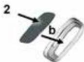
3. Plaats een nieuw P3 filter (2) (b) en zorg ervoor dat na montage het opschrift aan de buitenkant zichtbaar is.
