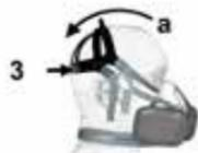
3. Coloque a fixação da cabeça (3) na parte de trás da sua cabeça (a).
