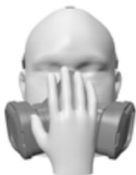
2. Adem normaal uit. Er is sprake van een correcte afdichting als het masker iets omhoog komt zonder dat er lekkage optreedt tussen het masker en het gezicht.
