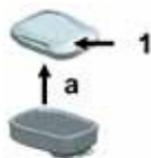
1. Ouvrez le couvercle du filtre (1) en le tirant (a) hors du boîtier de filtre.
