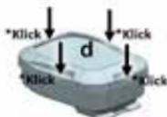
5. Nyomja a szűrőfedelelet a jelzett pontokon a szűrőház felé (d). A szűrőfedél bepattan a szűrőházba, jól hallható „kattanás” kíséretében.
