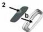
3. Sätt i ett nytt P3-filter (2) (b) och se till att märkningen är synlig från utsidan när det monteras.
