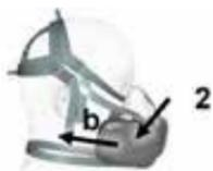
4. 将 A2P3 过滤器 (2) 向后拔出 (b)。
