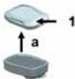
1. Abra la tapa del filtro (1) tirando (a) de la carcasa del filtro.
