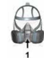
5. Nainstalujte kryt ventilu (1) znovu na tělo masky.
