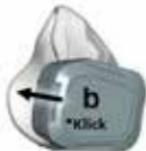
9. A2P3 filtrą spauskite link kaukės (b), kol jis užsifiksuos ir pasigirs aiškus spragtelėjimas.
