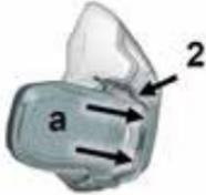
8. A2P3 filtresini hafif açılı olarak (a), filtre üzerindeki iki tırnağı kullanarak filtre tutucusuna (2) kaydırın.
