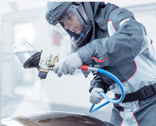
En homogen och till de aktuella behoven individuellt anpassningsbar sprutstråle – SATAjet X 5500 för högsta yt kvalitet
