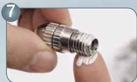
7 Graisser le filetage de la vis de réglage du flux de produit
