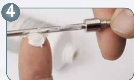
4 Graisser l'aiguille de peinture autour du joint
