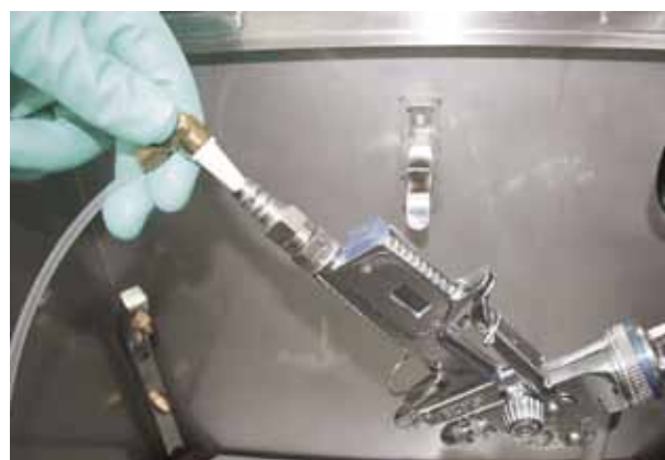
2. Brancher le raccord d'air à l'entrée d'air
