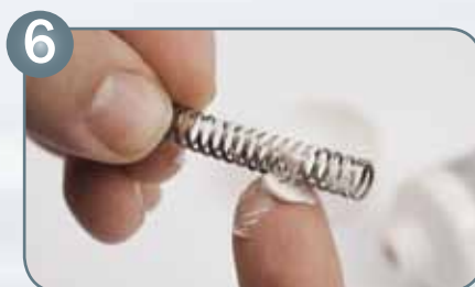
6 Graisser et installer le ressort de l'aiguille de peinture
