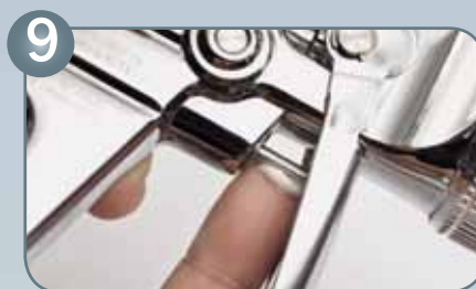
9 Graisser la partie visible de la tige du piston d'air
