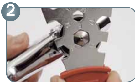
2 Serrer manuellement la buse de peinture à l'aide de la clé universelle
