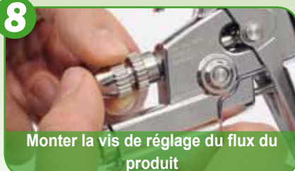
Graisser le filetage de la vis de réglage du flux du produit
