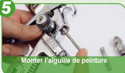
Graisser l'aiguille de peinture dans les alentours du joint
