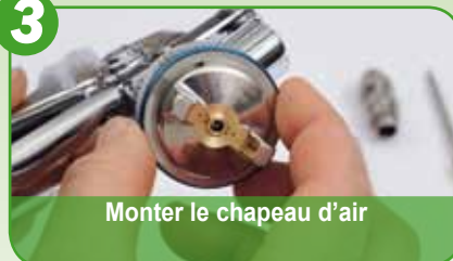
Serrer manuellement la buse de peinture à l'aide de la clé universelle
