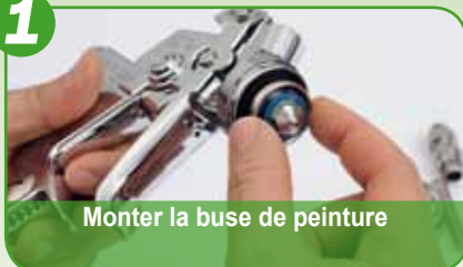
Serrer manuellement la buse de peinture à l'aide de la clé universelle
