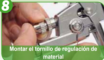
Engrasar la rosca del tornillo de regulación de material
