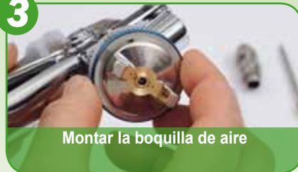
Atornillar robustamente la boquilla de pintura con la llave universal
