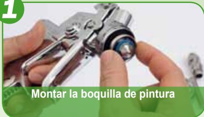
Atornillar robustamente la boquilla de pintura con la llave universal
