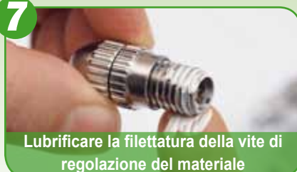
Montare la vite di regolazione del materiale
