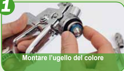
Stringere l'ugello del colore utilizzando la chiave universale a mano
