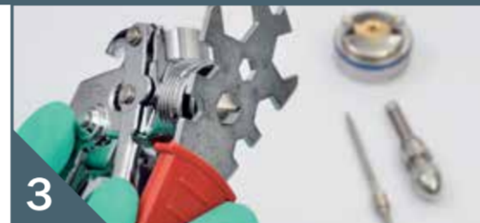
3 Desatornillar la boquilla de pintura con la llave de anillo
