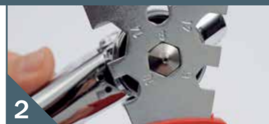
2 Atornillar robustamente la boquilla de pintura con la llave
