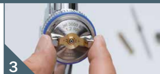
3 Montar la boquilla de aire - La rotulación de la boquilla de aire tiene que ser legible
