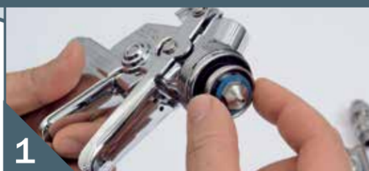
1 Montar la boquilla de pintura
