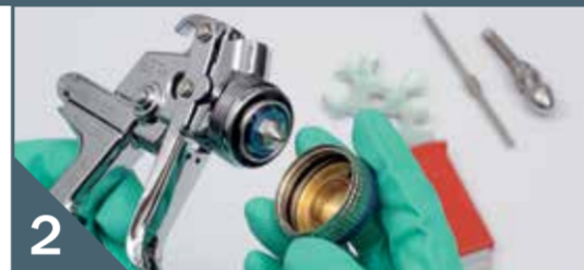
2 Después, proceder al desmontaje de la boquilla de aire
