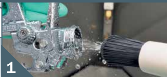
1 Limpeza del conducto de pintura
